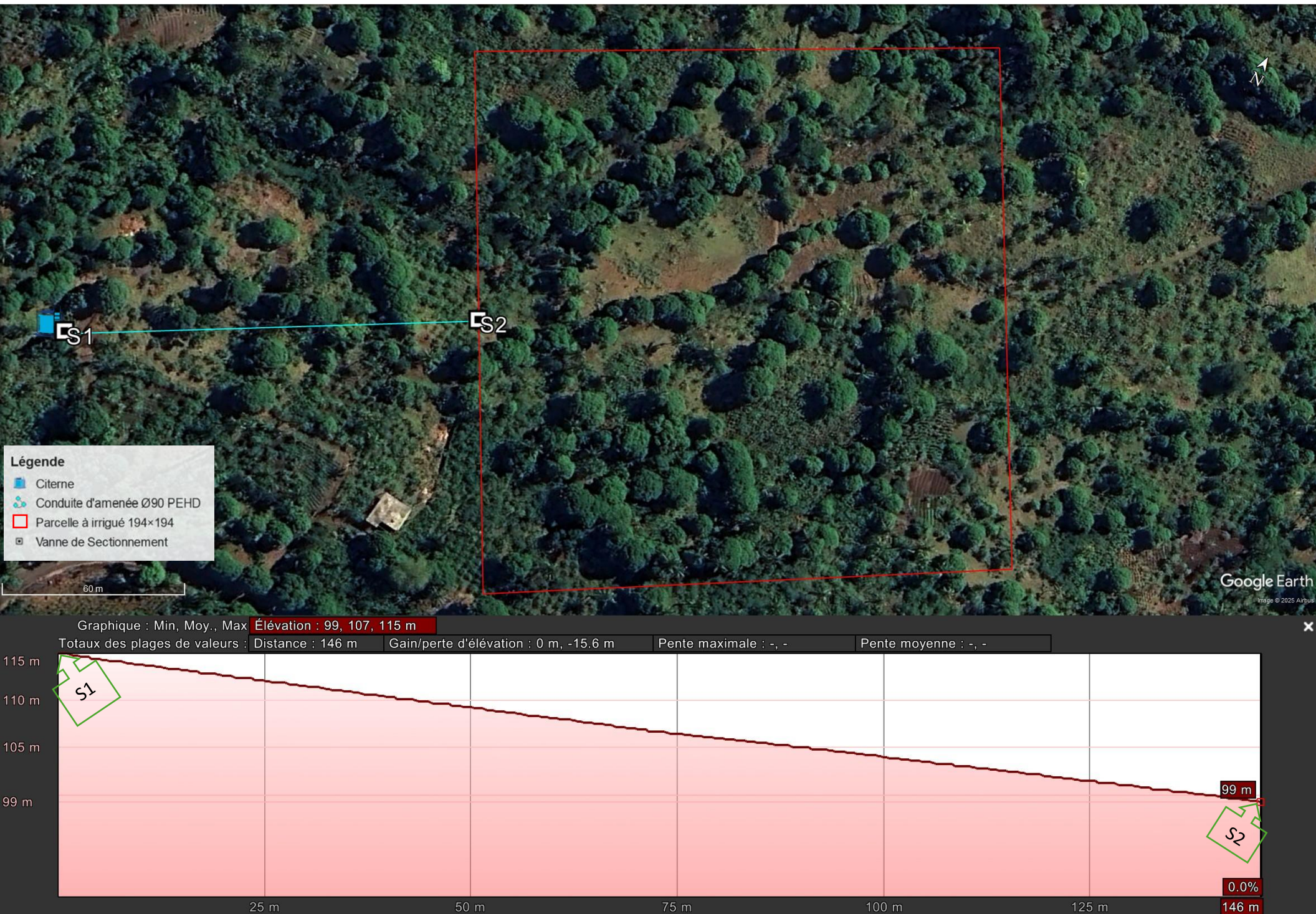
Figure 9: Tracé en plan et profil en long de la conduite d'amenée entre la citerne et la parcelle à irriguer à Kitarini, Bambao Mtsanga
