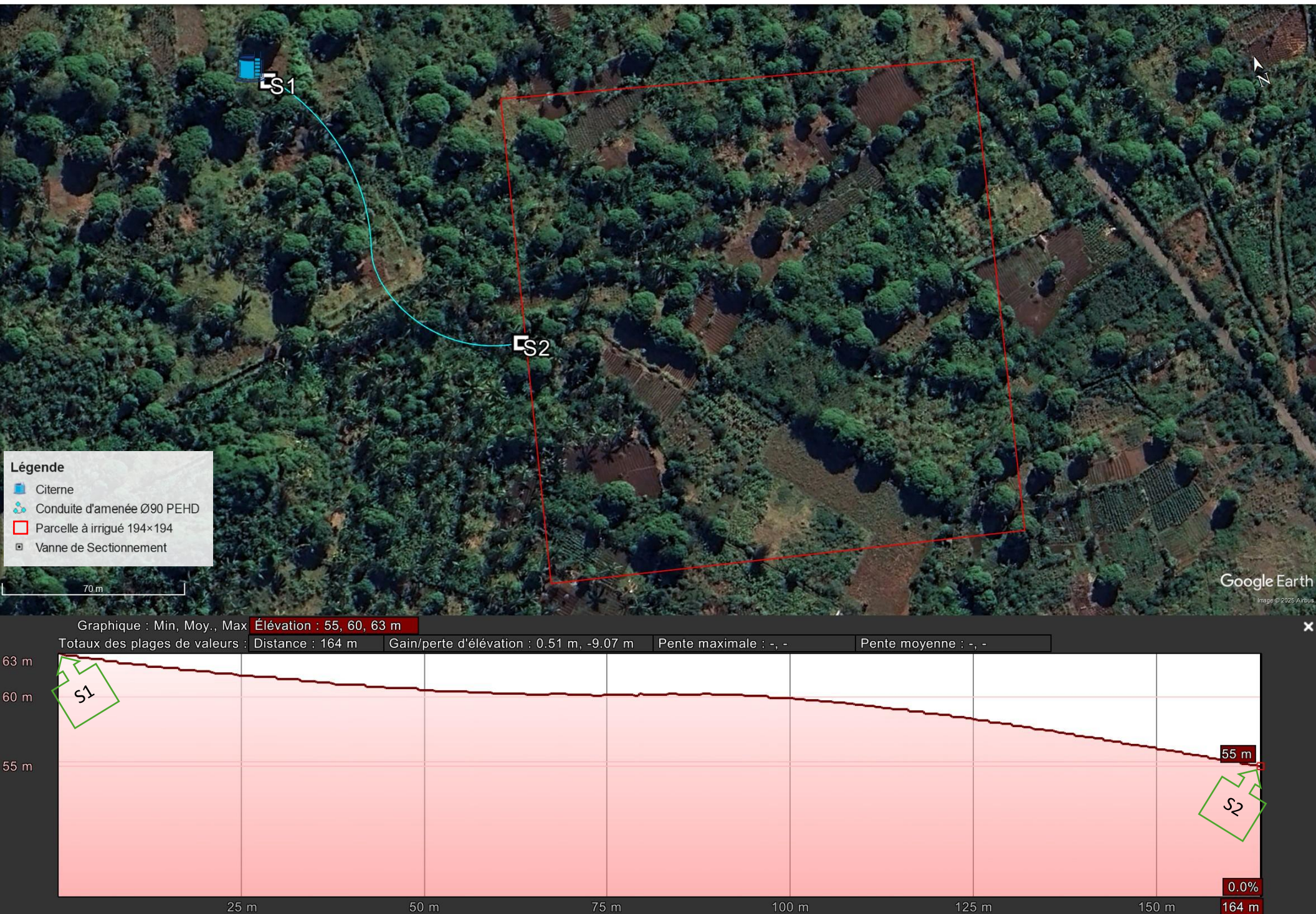
Figure 8:Tracé en plan et profil en long de la conduite d'amenée entre la citerne et la parcelle à irriguer à Marovojo, Bambao Mtsanga
