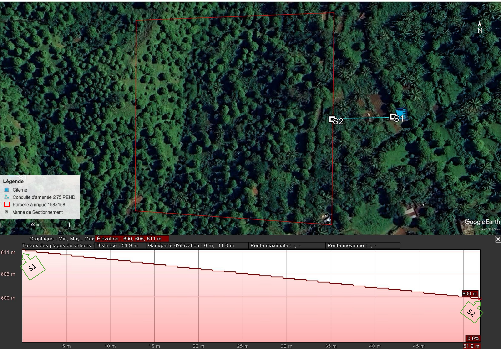
Figure 12: Tracé en plan et profil en long de la conduite d'amenée entre la citerne et la parcelle à irriguer à Daji, Mrémani
