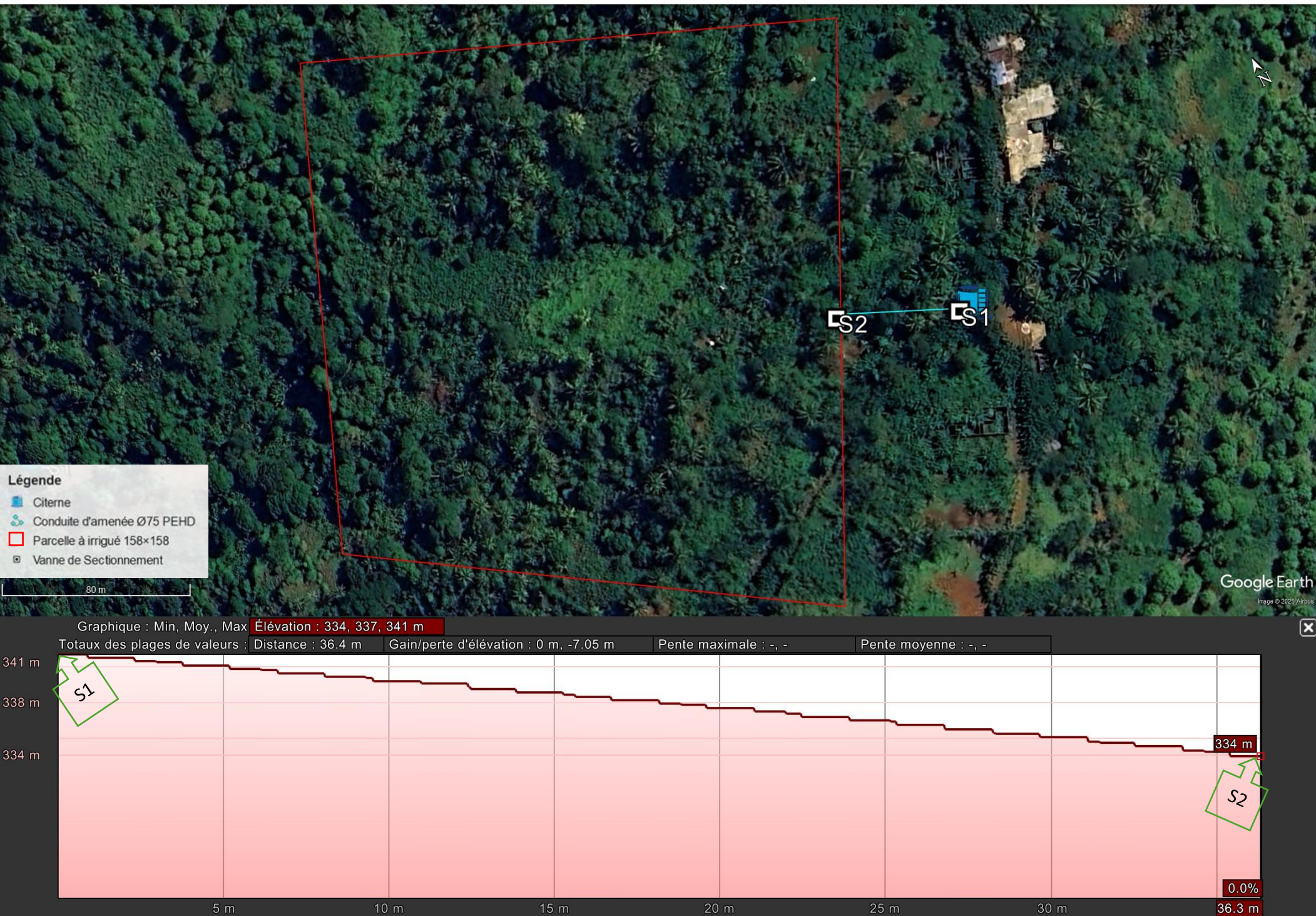
Figure 13: Tracé en plan et profil en long de la conduite d'amenée entre la citerne et la parcelle à irriguer à Chaweni, Bandramaji
