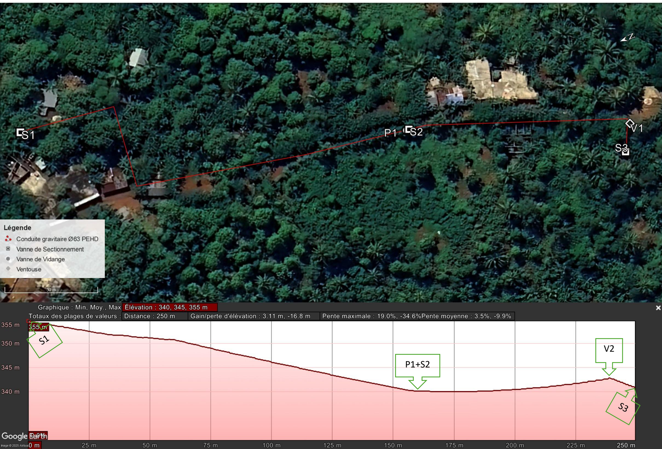
Figure 6: Tracé en plan et profil en long de la canalisation entre le point de captage et la citerne de Chaweni
