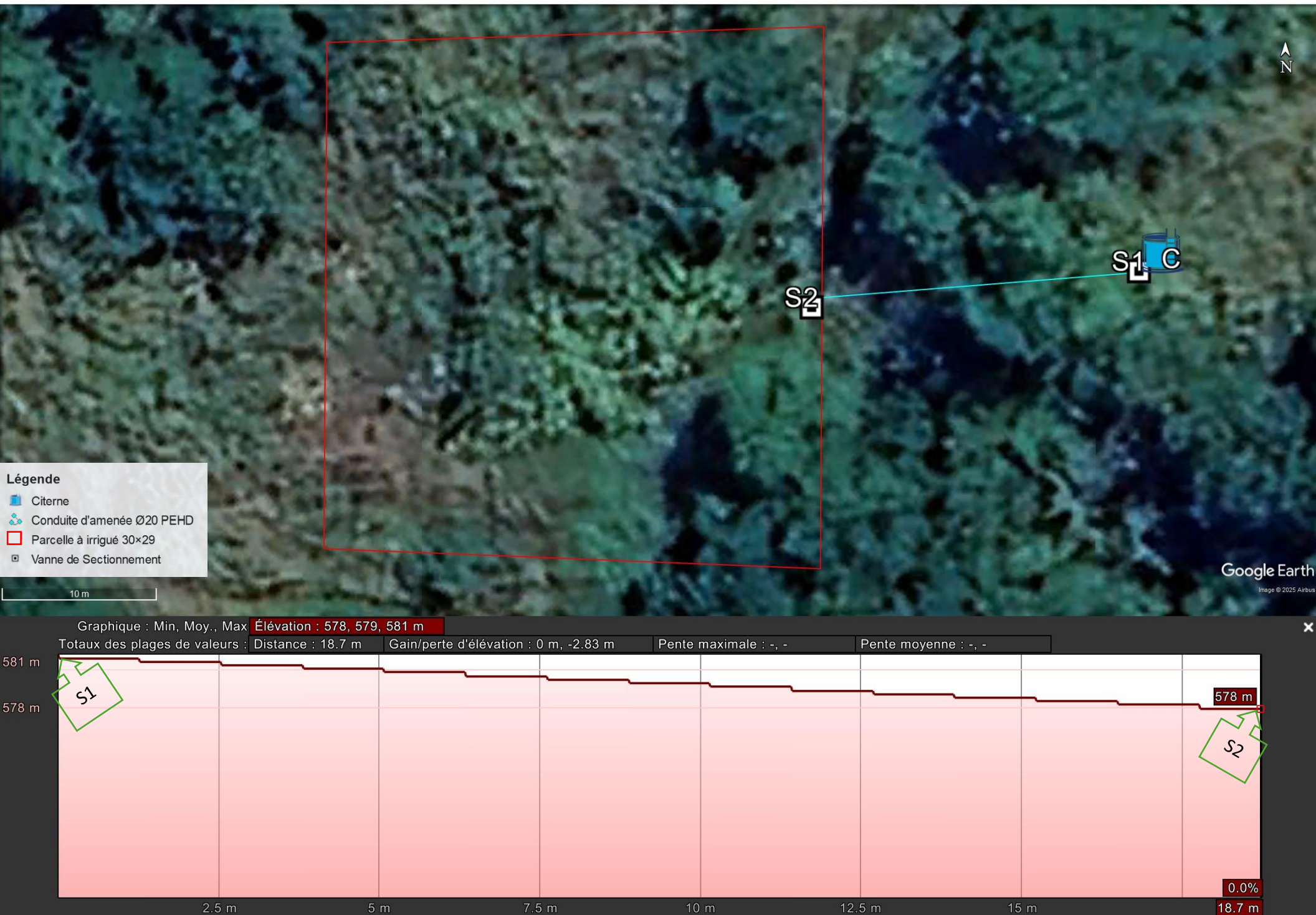
Figure 15: Tracé en plan et profil en long de la conduite d'amenée entre la citerne et la parcelle à irriguer à Itsoundzou, Dzahadjou
