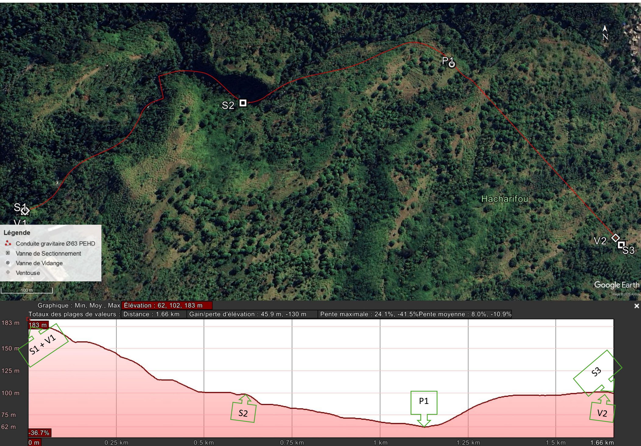
Figure 3: Tracé en plan et profil en long de la canalisation entre le point de captage et la citerne de Hacharifou, Domoni
