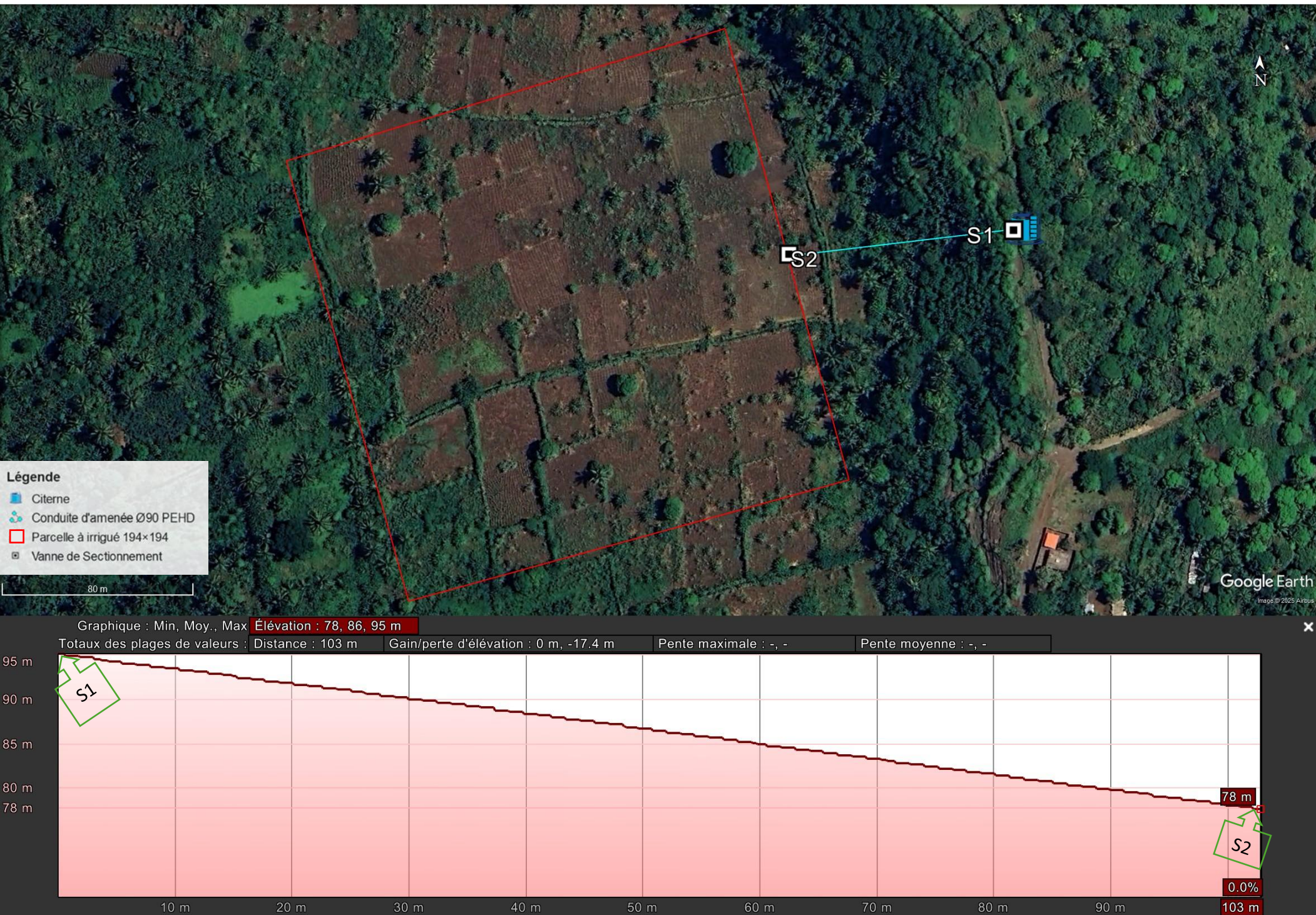
Figure 11: Tracé en plan et profil en long de la conduite d'amenée entre la citerne et la parcelle à irriguer à Mahindrini, Domoni
